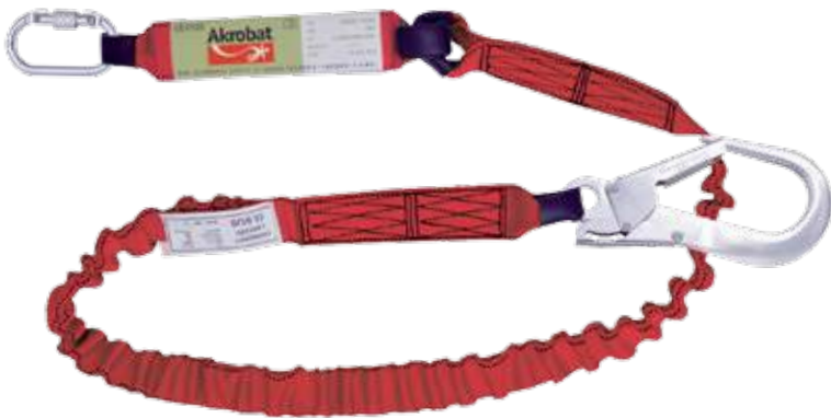
AK398 CORDE ÉLASTIQUE EN355 Corde élastique avec absorbeur d'énergie. Crochet d'ouverture 60 mm et un mousqueton. Son avantage est qu'il est moins encombrant. Longueur « détendu » 1,4 m et tendus 2 m. Vérifier qu'entre l'ancrage et le sol il y est au moins 6 mètres. Emballage : 5 pcs.
