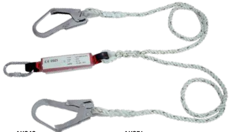
AK349 CRABE EN362 Longueur 1,5 mètre. Absorbeur d'énergie avec deux crochets et un mousqueton. Idéal pour déplacer tout en conservant un point d'ancrage fixe. Exemple: Entretien sur le bras de la grue, grimper sur des pylônes, etc... Vérifier qu'entre l'ancrage et le sol il y a au moins 6 mètres. Emballage : 5 pcs.
