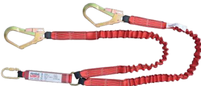
AK371 CRABE AVEC SANGLE ELASTIQUE Absorbeur d'énergie avec une sangle élastique et deux crochets et un mousqueton. Idéal pour se déplacer tout en conservant un point d'ancrage fixe. Ex: entretien sur les grues, grimper sur des pylônes, etc. Vérifier qu'entre l'ancrage et le sol il y a au moins 6 mètres. Longueur: 1,4/1,6 mètres avec élastique « détendu » ; avec élastique tendu 2,0 mètres. Emballage : 10 pcs.
