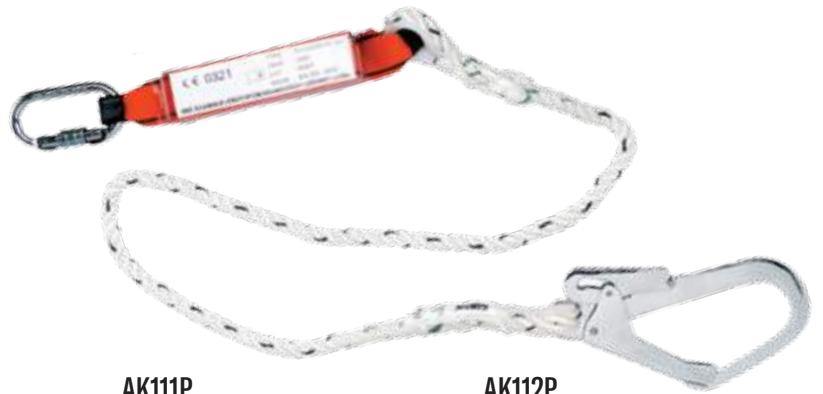
AK111P LONGE AVEC ABSORBEUR D'ENERGIE EN355 Longueur 1,5 mètre. Longe avec absorbeur d'énergie, équipée d'un crochet avec ouverture 60mm et un mousqueton. S'assurer qu'entre le point d'ancrage et le sol ou le risque plus proche, il y a au moins 6 mètres. Emballage : 5 pcs.
