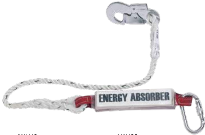
AK111S LONGE AVEC ABSORBEUR D'ENERGIE EN355 Longueur 1,5 mètre. Longe avec absorbeur d'énergie, équipée d'un crochet et un mousqueton. S'assurer qu'entre le point d'ancrage et le sol ou le risque plus proche, il y a au moins 6 mètres. Emballage : 5 pcs.
